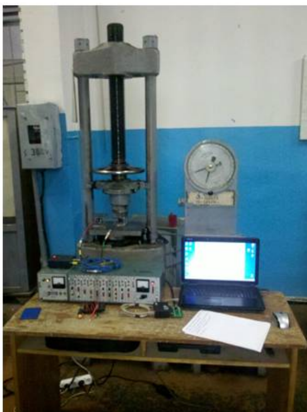
Рисунок 2.4 – Фото процесса тарировки месдоз (а) и тарировочная зависимость (б)
