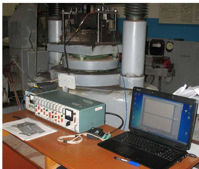
Рисунок 2.2 – Измерительная система лабораторных пресс-ножниц кафедры «Механика и пластическое формование» Донбасской государственной машиностроительной академии
