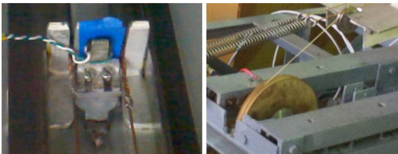
Рисунок 2.11 – Индикатор начала деформации пружин (а) и датчик перемещения полосы (б)
