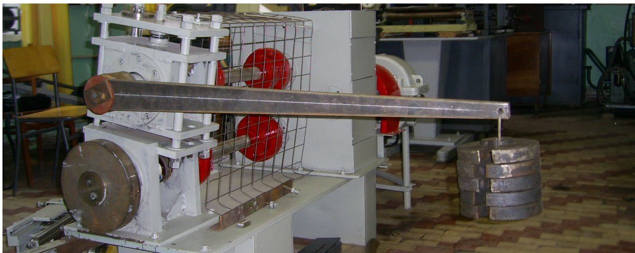
Рисунок 2.15 – Фото тарировки верхнего ножевого вала лабораторной установки однопарных дисковых ножниц кафедры «Машины металлургического комплекса и прикладная механика» Донбасского государственного технического университета
