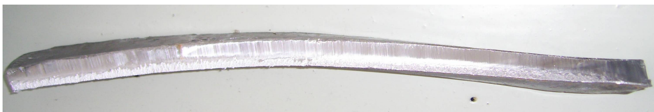
Рисунок 4.16 – Фото образцов разрезанных на двупарных (а) и однопарных (б) дисковых ножницах
